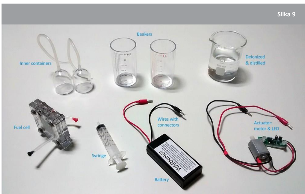
↑ Oprema, potrebna za izdelavo sistema gorivnih celic.
