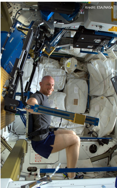
↑ Astronavt ESA Alexander Gerst na mednarodni vesoljski postaji uporablja napravo ARED (Advanced Resistive Exercise Device), da ohranja telesno pripravljenost s simulacijo dvigovanja uteži s pomočjo zračnega pritiska namesto običajnih uteži.
