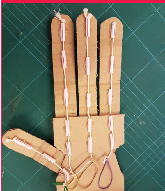
↑ Bionična roka, izdelana iz kartona
