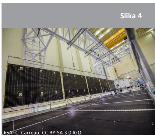
↑ Namestitev sončnega krila na modul za transfer BepiColombo.
