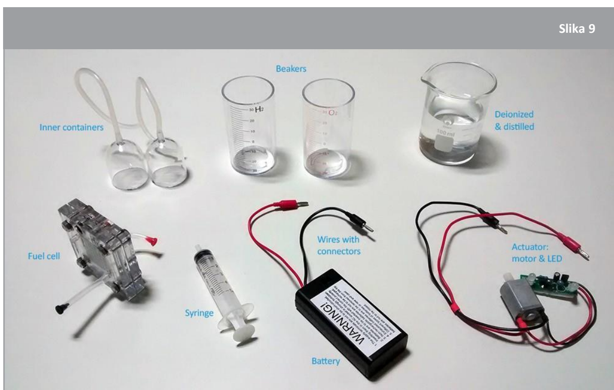
↑ Oprema, potrebna za izdelavo sistema gorivnih celic.
